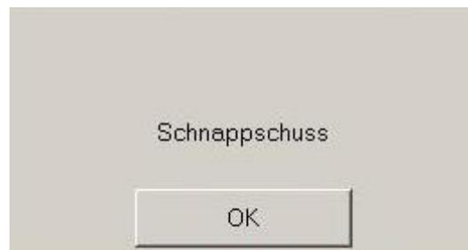
Um an das Bild zu gelangen, muss ein USB-Stick im USB-port mit dem Namen “Data Export” stecken. Der Benutzer wählt das Feld **[Stop]** im oberen Bereich des Bildschirms aus. Es öffnet sich ein neues Fenster, wählen Sie **[Export]**. Das Bild wird auf den Stick gespeichert. Jeder file-Name folgt der Regel: Stunde - Minute - Monat - Tag - Jahr.
