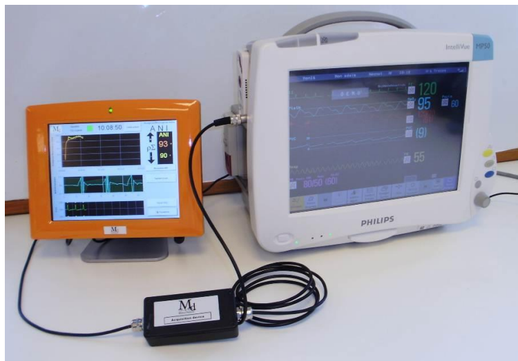
Obr. 3 – příklad propojení monitoru s monitorem Philips MP50
