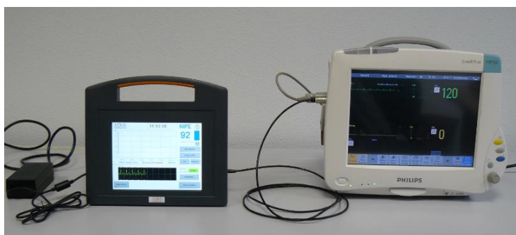
Obr. 2: Příklad propojení s monitorem Philips MP50
